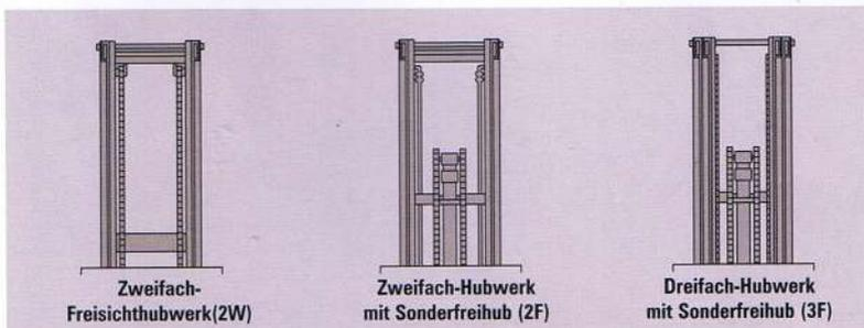
Das Zweifach-Freisicht-Hubwerk (2W) gehört zur Serienausstattung der F03 Gabelstapler-Serie. Das Zweifach-Hubwerk mit Sonderfreihub (2F) ist ein neues Freisichtmodell, ausgestattet mit drei Hub-Zylindern. Die Anordnung der hydraulischen Leitungen und Ketten des Dreifach-Hubwerks mit Sonderfreihub (3F) garantiert hervorragende Sicht nach vorne.
